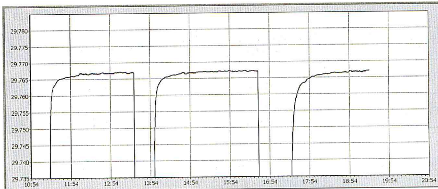
ампула Г-25–7,5 № 1 по эталонному термометру типа Leeds @ Northrup в калибраторе температуры RTC-157B (10.02.11)
