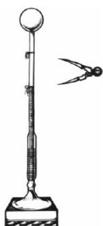
Рисунок 1 – Один из первых воздушных термометров или термоскоп. Измеренные температуры отмечались с помощью шнурка, а для измерения степени изменения использовались деления.
