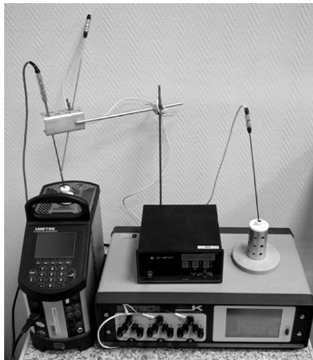
Рис. 4. Экспериментальная установка для исследования иммерсионной составляющей погрешности измерений сопротивления чувствительного элемента термометра
