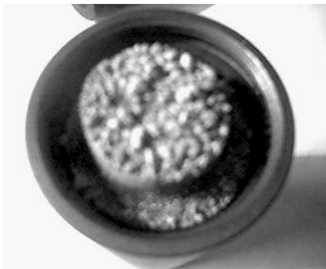
Рис. 1. Исходная порошкообразная смесь для заправки эвтектики Pt-C
