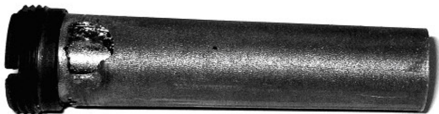
Рис. 2. Палец тигля реперной точки меди с наплавленной на него медью
